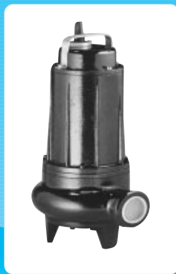
SD 32-40-50 2 POLES Kw = 0,28 ÷ 1,5 Q = 30 ÷ 700 l/1 H = 5 ÷ 18 m
